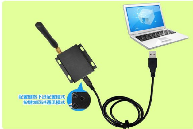
数传模块USB接口连接示意图
